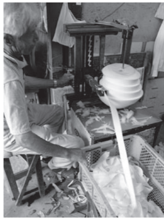
▲実は電動の機械を使い、30秒ほどでけずられる
