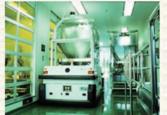
▲錠剤製造工程(無人搬送車で運搬)
