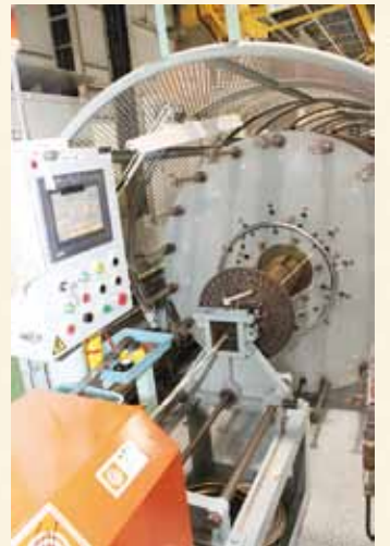
▲導体および線心をより合わせる工程
