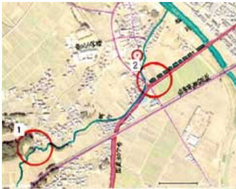
城川屈曲蛇行・バイパス分水路
