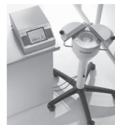
給食センターに配備されるガンマ線スペクトロメーター
