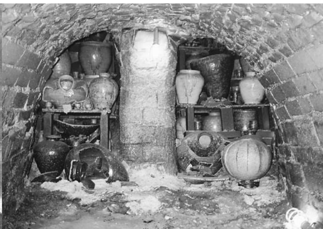
▼ 焚口から覗いた穴窯内部。前方の作品は崩壊していたが…。双胴を隔てる仕切り壁が見える
