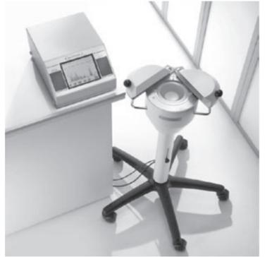
▲学校給食センターに設置するガンマ線スペクトロメータ
