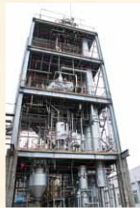
▲使用済溶剤を精製する蒸留塔
