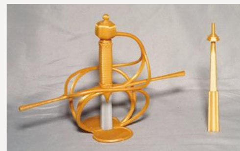
▲右：剣身の雄ネジと雌ネジの固定位置 左：造形したパーツを組んだところ
