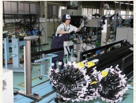
▲集合配管のPIPE曲げ工程
