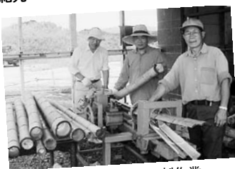
▲竹割機による竹割作業
