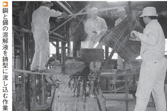
銅と錫の溶解液を铸型に流し込む作業
