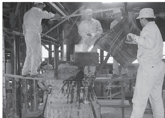
銅と錫の溶解液を鑄型に流し込む作業
