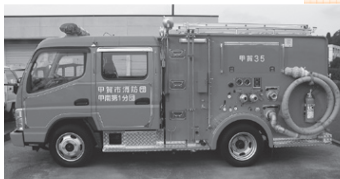
▲新しく購入した水槽付消防ポンプ車
