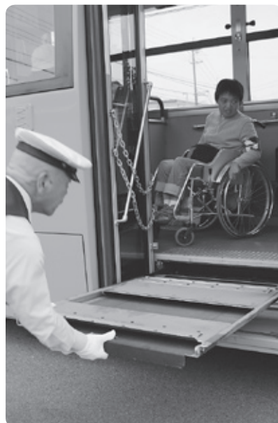
収納式スロープが設置されている低床バス
